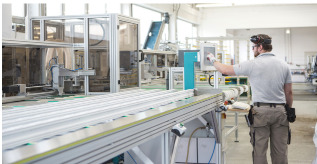
Die Fensterkonstruktionen entstehen am Computer und werden über CNC-Maschinen verarbeitet: Sägen, Verschweißen, Bohren – alle Arbeitsgänge finden in Stade statt.
